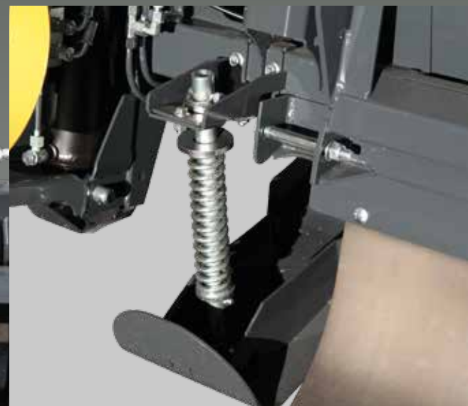
Опціональні стернепритискачі захистять колеса вашого комбайна.
